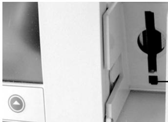
Abbildung 11: Auswurfschalter CF-Card
